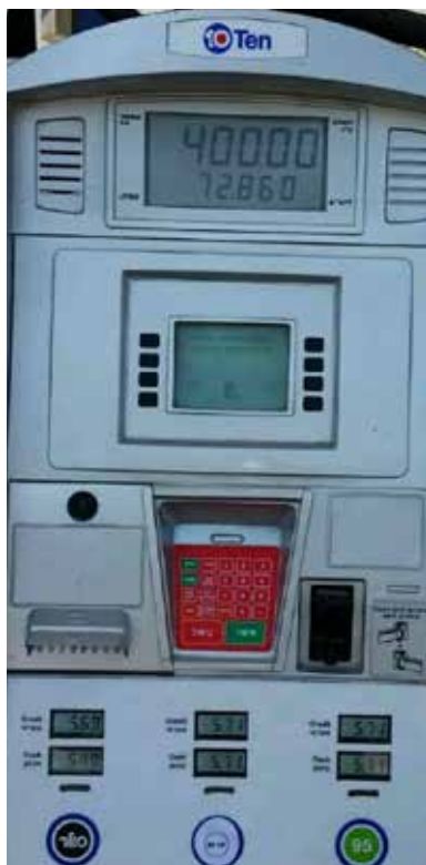
图 16. 以色列一家加油站的汽油和柴油加油机旁的 M15 加油泵和 M100 加油泵
